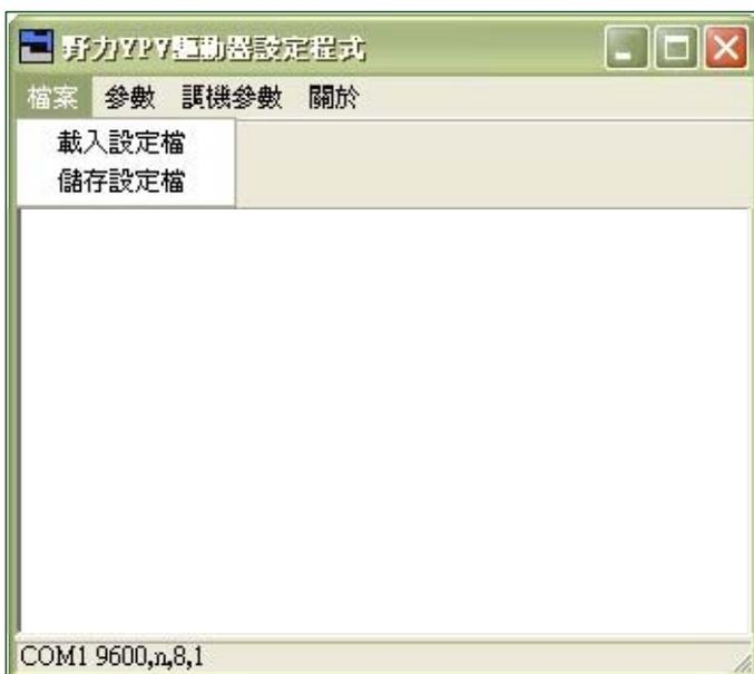
**2.1.1 載入設定檔**→選定前儲存名稱→載入→自動將檔覆蓋完成→驅動器關閉電源再重新開啓→完成載入步驟。
